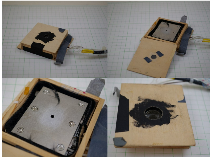
図 1: 手作り感満載のホットステージ。上板は 2mm の合板で、裏側にカバーガラスをポリイミドテープで貼り付けている。枠の内側にあるのはカーボン系の断熱材。
