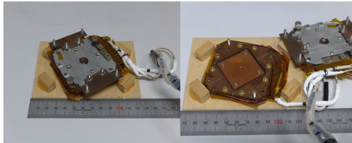
図 15: 両面加熱型ホットステージ。全体の対称性を高くするためヒーターを片面 4 枚、合計 8 枚使っている。
