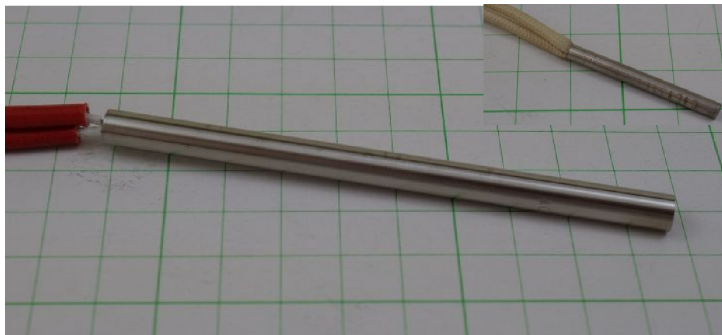
図 7: カートリッジヒーター。左の物は直径 6.5mm、長さ 100mm で定格は 100V-100W。右上のものは、直径 1/8 インチ (約 3.1mm)、長さ 5/4 インチ (31.8mm)。定格は 120V-50W。単位表面積当たりの発熱量は小さい方が遙かに大きく、伝熱に注意しないと寿命が短くなる。個人的には可能な限り表面の発熱密度が低いものを選ぶようにしている。
