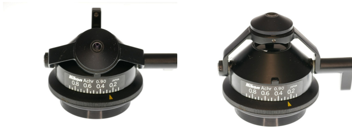
図 7: 偏光顕微鏡に標準的に装着されていることの多いハネノケコンデンサ。上玉を外した状態と光路に入れた状態。
