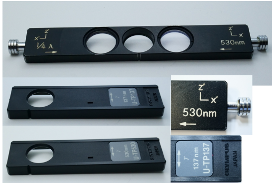
図 11: \lambda/4 波長板と鋭敏色板。ニコンの製品（上）は一つの板に両方ついていて本体に付属している。オリンパスはオプションで別々に供給されている。
