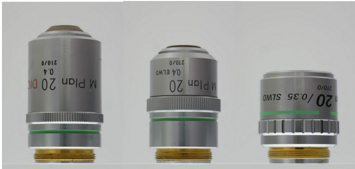
図 13: 左側から普通の 20 倍対物レンズ、長作動 (ELDW) 対物レンズ、超長作動 (SLDW) 対物レンズ。取り付け面からピントがあう位置までの長さは同じ。
