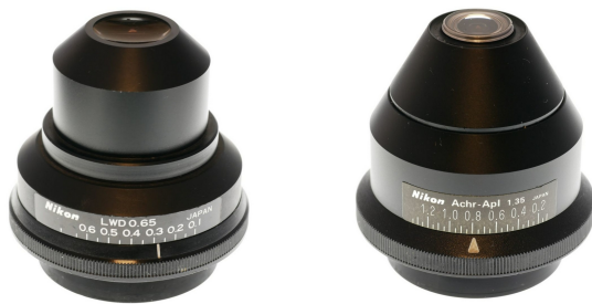
図 28: 長作動コンデンサと AA コンデンサ。これらは正立顕微鏡用で、長作動コンデンサの作動距離は 10mm。AA コンデンサの NA は 1.35 となっているが、これは油浸で使用した場合。
