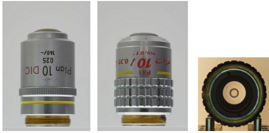
図 16: 位相差用対物レンズ、微分干渉用対物レンズ。微分干渉用は見た目も普通の対物と変わらないが、位相差用はレンズを覗き込むとリングが見える。
