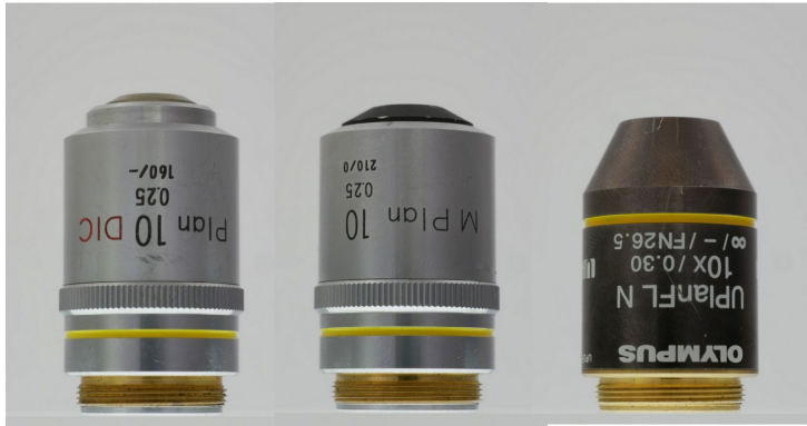
図 13: RMS 規格の有限系 160mm 鏡筒用・210mm 鏡筒用と無限遠補正系対物レンズ。それぞれ、160、210、 \infty 記号がある。いずれも同程度の焦点距離の凸レンズなので、異なるシステムに取り付けても結像する。同焦点距離は 45mm であるが、設計とは異なる規格の鏡筒に取り付けると同焦点距離も変化する。
