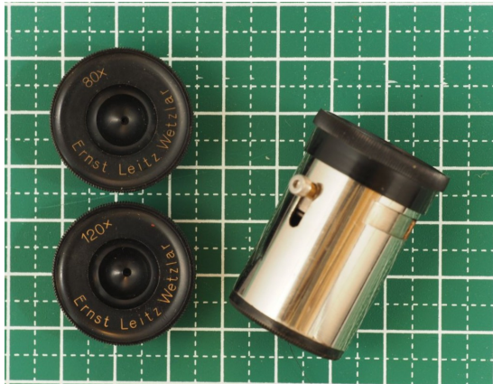
図 1: 単式ポケット顕微鏡。右側の接眼レンズのようなものが顕微鏡本体。アイピースに見える部分に小さな凸レンズが組み込まれた単式顕微鏡で、拡大率は 40 倍、80 倍、120 倍の 3 種類が用意されている。本体のスリット部分にプレパラートを入れて観察する。
