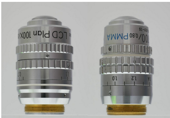
図 20: 特殊な補正環付き対物レンズ。液晶観察用の対物レンズも補正環があるものがある。生物系とは違って、液晶セルに用いられているガラス厚範囲に対応したものとなっている。少し特殊な例として、ガラスではなく高分子材料に対する補正環がついているレンズもある。CD などの観察に用いられる。
