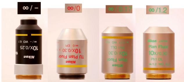
図 14: カバーガラス厚指定。カバーガラス厚のズレによる球面収差は NA が大きいほど影響が大きい。低 NA の影響が無視できる対物レンズでは無指定（「-」表記）のものもある。通常のカバーガラスを用いるものでは、「0.17」、カバーガラスを用いないものは「0」
