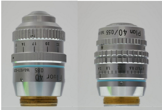
図 19: 補正環付き対物レンズ。高 NA の乾燥系対物レンズではカバーガラスの厚みの違いに対応するために補正環がついている。あまり NA の高くない生物用の長作動対物レンズの中には、シャーレ越しの観察に対応できるように、2mm 程度までのガラス厚に対応できる補正環がついているものもある。
