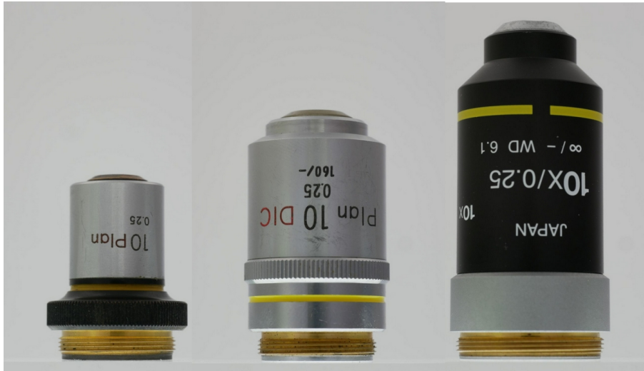
図 12: 短頸対物レンズ、有限系及び∞系長頸対物レンズ、ニコン CFI60 対物レンズ。いずれも 10 倍で、NA 値もほぼ同じ。顕微鏡対物レンズの筐体が大きいかほどレンズ設計の自由度が増す。一方で顕微鏡全体の大きさも大きくなってしまい、使い勝手に問題が生じる可能性もある。
