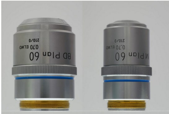
図 17: 明暗視野用と明視野用対物レンズ。両方の対物レンズ本体のレンズ構成は（おそらく）同一）だが、明暗視野用は暗視野照明部分がレンズ本体の外周にあるため本体と取り付けねじ径が大きくなっている。
