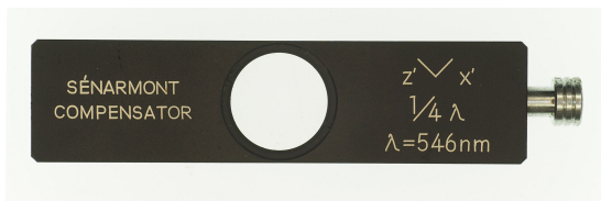
図 33: セナルモンコンペンセータ。軸方位が通常のコンペンセータと 45^\circ 異なっている。
