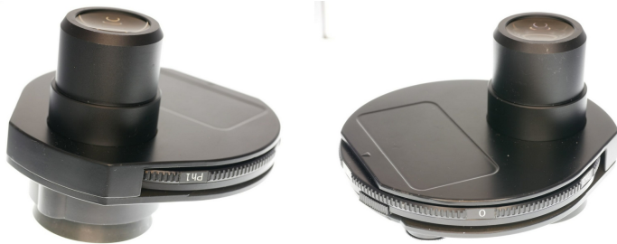
図 29: 倒立顕微鏡用のコンデンサ。大きなターレットは位相差リングの切り替えのもの。NA0.5 で作動距離は 20mm を超えており、メトラー社のホットステージでもケラー照明やコノスコープ観察が可能。ニコンの Optiphot、オリンパスの BH2 へは装着できることが確認されている。
