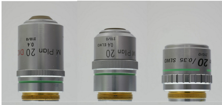
図 21: 左側から普通の 20 倍対物レンズ、長作動 (ELDW) 対物レンズ、超長作動 (SLDW) 対物レンズ。取り付け面からピントがあう位置までの長さは同じ。
