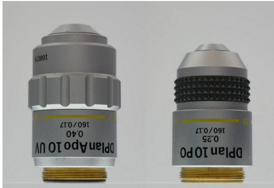
図 11: アポクロマート対物とアクロマート対物レンズ。両方とも 10 倍の対物だが、アポクロマートは NA=0.4 なのに対して、アクロマートは NA=0.25 しかない。一方、レンズ長が異なることから分かるように、アクロマートの方が作動距離が長い。
