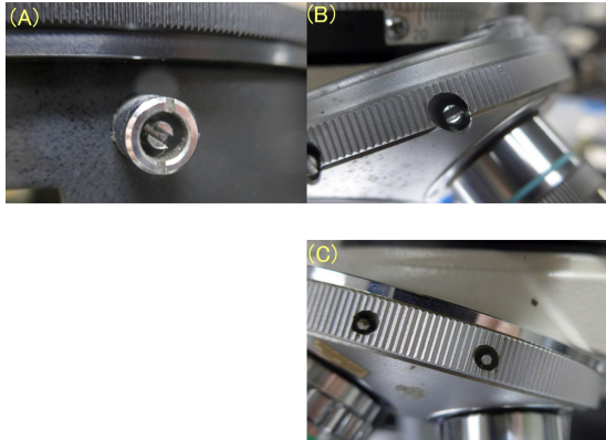
図 45: オリンパス BH2 は回転ステージにも芯だし機構がある。このためレボルバー側の一つには芯だし機構がない。ニコンのオブチフォトは、ステージ側には芯だし機構がなく、すべてのレボルバー穴に芯だし機構がある。BH2 はマイナスドライバーで芯だしできるが、オブチフォトは特殊な工具が必要である。
